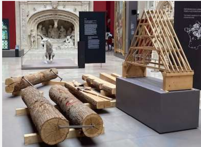
Grumes à différents stades d'équarrissage, doloire et hache de dégrossi Maquette d'étude d'une travée de la nef
